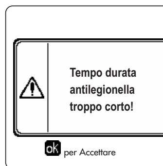
fig. 27 - Messaggio Funzione antilegionella non conclusa
